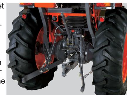
**Voor een betere toegang en makkelijker op - en afstappen is de aftakashendel aan de rechterkant van het spatbord geplaatst.**
