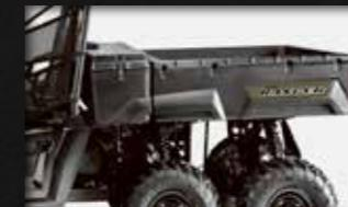
Met zijn composieten laadbak en hoge capaciteit (groter dan pallet), en een laadvermogen tot 567 kg. Daarnaast is de bak uitgerust met het unieke "Lock & Ride" systeem.
