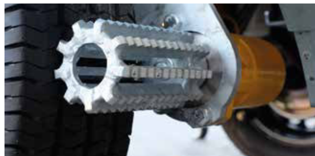
Aandrijving via wrijvingsrollen op beide banden
