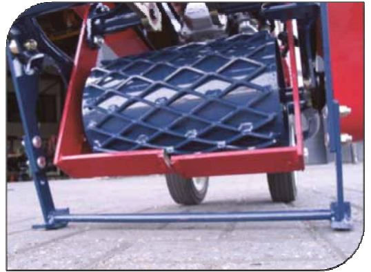
Gedeeld mes met tegengestelde werking om vibraties te verminderen
